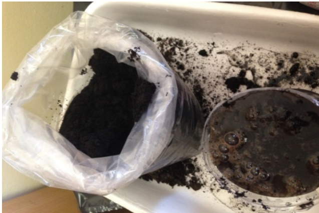
Foto n. 3- Bollicine di gas che fuoriescono dal terriccio mentre penetra l'acqua.
